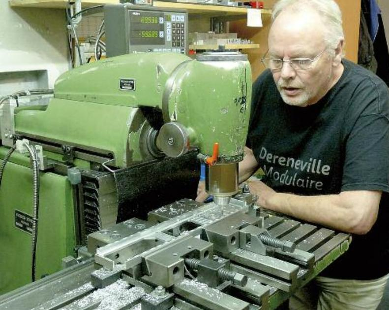
Außer größere Dreharbeiten werden alle metallverarbeitenden Arbeiten von Rainer Horstmann in seiner sprichwörtlichen hauseigenen Werkstatt ausgeführt, auf einer Deckel-FP2-Werkzeugfräsmaschine...
