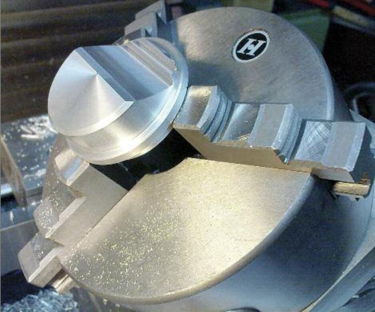
Von komplexen Teilen wie diesem hier, werden in mehreren Arbeitsschritten bei einer Genauigkeit im Mikrometerbereich auf der Werkzeugfräsmaschine insbesondere beim Tangentialtonarm viele hergestellt
